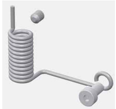
Abb. 3.6 Türfeder, Madenschraube und Spannschraube
