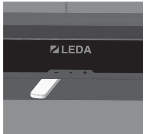
Abb. 3.13 Luftschieber ganz links, Symbol „-“ Verbrennungsluft geschlossen
