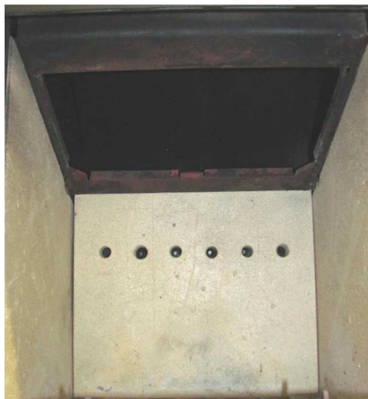
Abb. 9: Feuerraum ohne HiClean-Filter®
