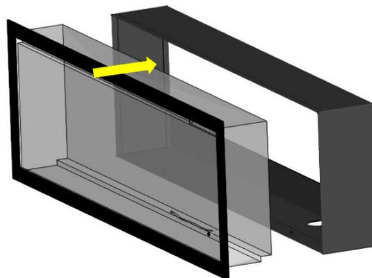
Bild 7: Elektrokamin einschieben
