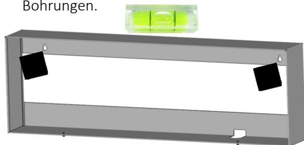
Bild 4: Einschubkasten ausrichten und anzeichnen
