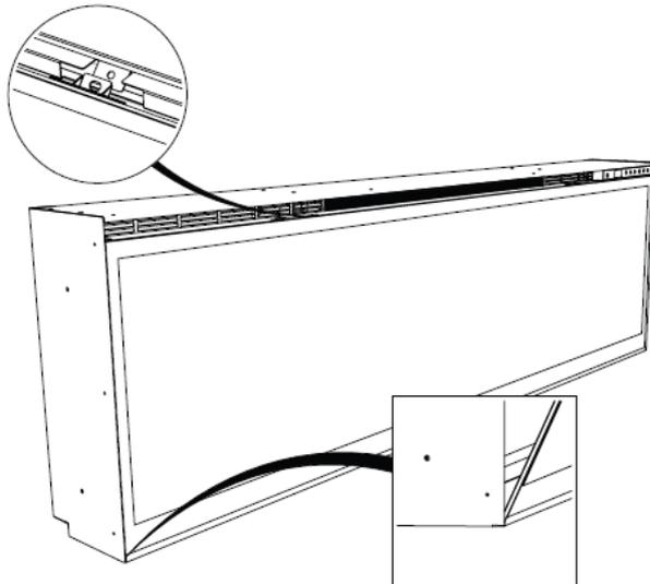
Bild 11: Befestigung Frontglas
