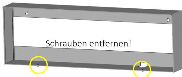
Bild 6: Sicherungsschrauben entfernen
