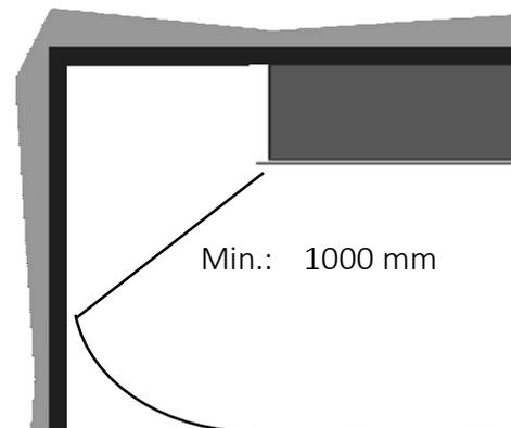
**Bild 1:** Sicherheitsabstände zu brennbaren Gegenständen und optimale Montagehöhe
