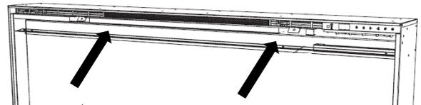
**Bild 9: Entfernen der oberen Glashalterung**
