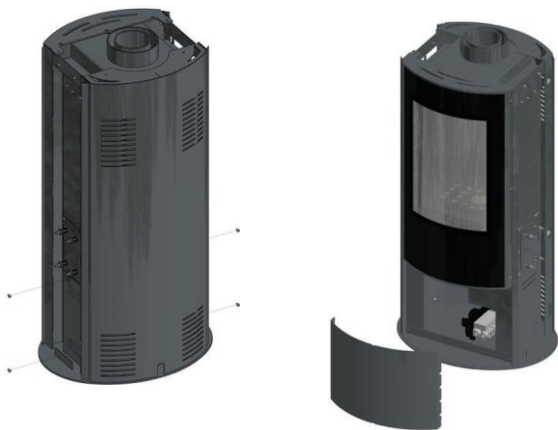
Abb. 9. Demontage der unteren Tür im Raumheizer RO/G
