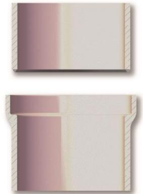
Bild: nach anfeuchten der Falzflächen der Elemente, wird der Säurekitt keilförmig an den Steckenden des Elementes
