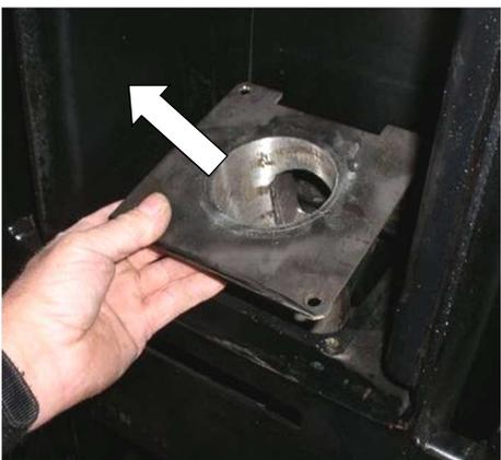
Abb. 114: Entnahme Brennerkopf
