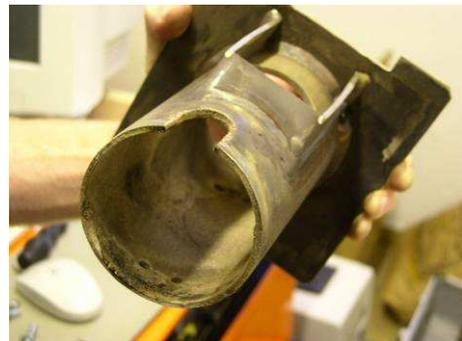
Abb. 116: Gereinigter Brennerkopf
