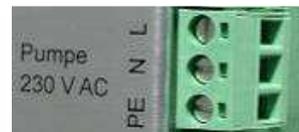
Abb. 75: Ausgang Pumpe
