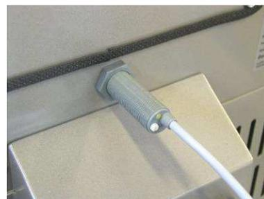
Abb. 63: Eingebauter Füllstandsmelder
