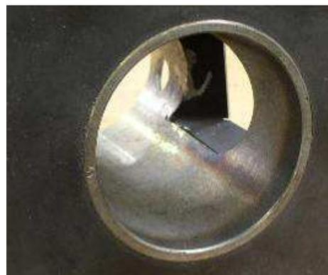
Abb. 117: Gereinigter Brennerkopf
