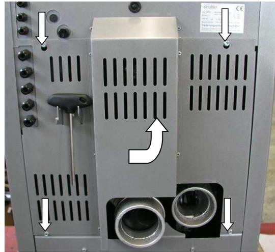
Abb. 23: Seitenverkleidung hinten oben
