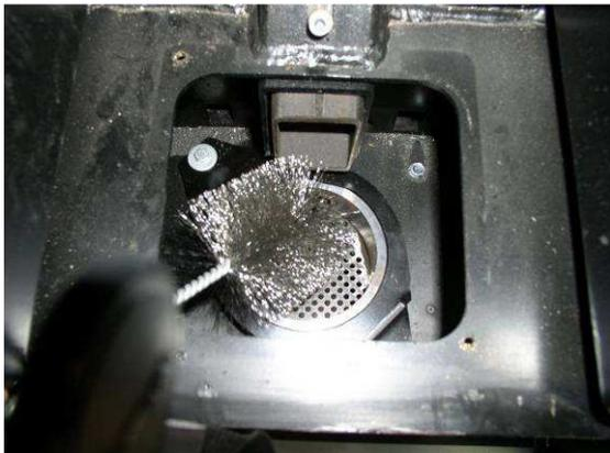
Abb. 122: Schwenkrost reinigen
