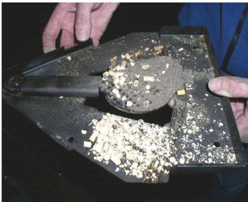
Abb. 128: Schwenkrost vom Träger entfernen
