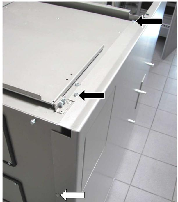
Abb. 16: Demontage Seitenverkleidung ivo.safe®
