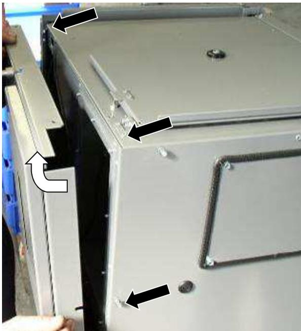
Abb. 13: Demontage Seitenverkleidung
