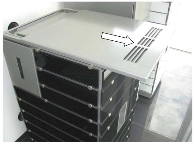
Abb. 86: Gerätedeckel BM01 „ivo.tec“ verschieben
