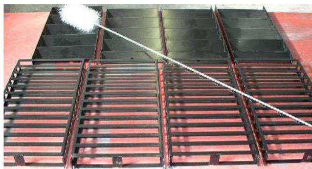
**Abb. 141: Turbulatoren und WT- Rechen**
