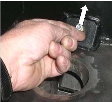
Abb. 113: Repetierhebel nach oben drücken!
