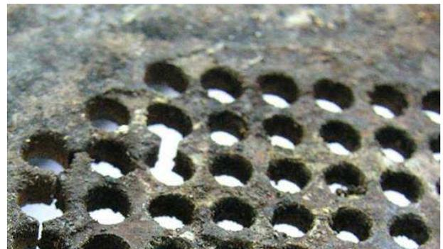
Abb. 126: Schwenkrost gerissen
