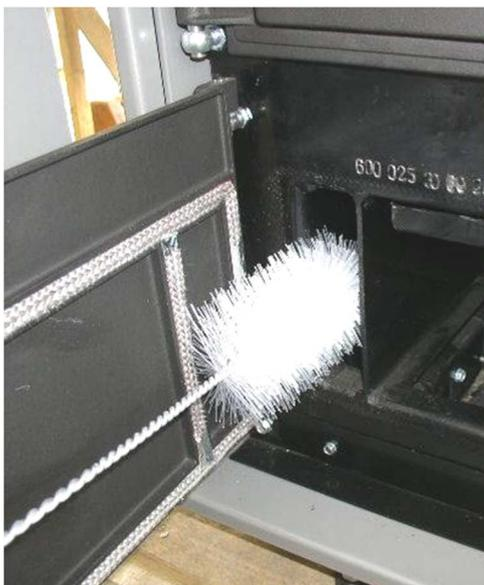
**Abb. 138: Reinigung Heizgaszüge unten**
