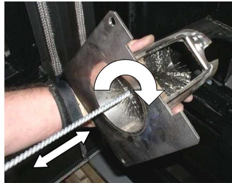
Abb. 115: Reinigung des Brennerkopfes
