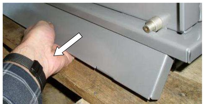
Abb. 3: Entfernen Sockelblenden
