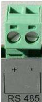
RS 485 - BUS-Eingang zum Ein-/Ausschalten und zur Modulation der Ofenleistung über einen externen, mit passender Bus-Kommunikation ausgestatteten Heizungsregler (Zubehör). Der Eingang „Bus“ muss zur Verwendung vorher aktiv geschaltet werden.
