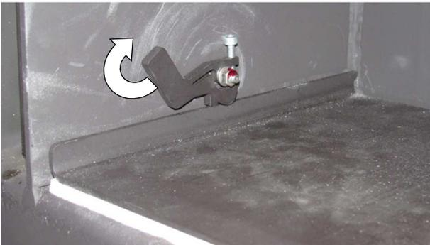
Abb. 106: Arretierung Abdeckplatte geschlossen
