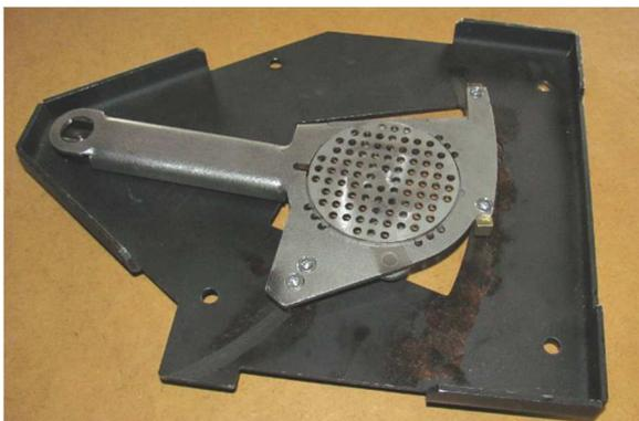
Abb. 129: Rostträgerplatte mit Schwenkrost
