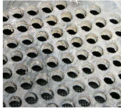
Abb. 124: Schwenkrost richtig gereinigt
