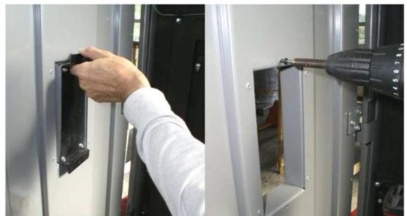
Abb. 25: Demontage / Montage Sichtblende
