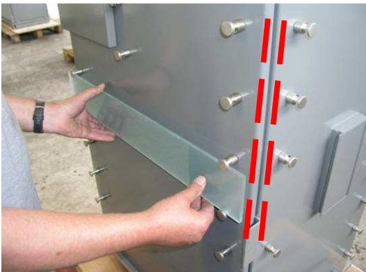
**Abb. 33: Ausrichten Dekorglas**
