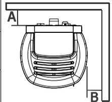
Wenn der Fußboden aus brennbarem Material ist, empfehlen wir, einen Schutz aus nicht brennbarem Material zu verwenden (Stahl, Glas, ...), der auch den frontalen Teil vor einem eventuellen Herabfallen von Brennstoff während der Reinigungsoperationen schützt.
