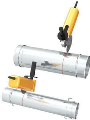
3. Rohrteile mit Hilfe eines Trennschleifers o. ä. durchtrennen.
