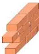
Abb. 3 Beispiel, Befestigung in Mauerwerk mit Injektionsanker
