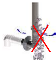
Abb. 5 Verbrennungsluft-Ansaugung frei halten
