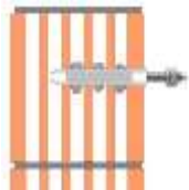
Abb. 3 Beispiel, Befestigung in Mauerwerk mit Injektionsanker
