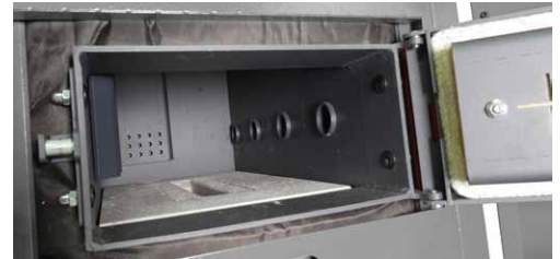
Abb. 14: Heizkesselwand / Öffnung Primärluft
