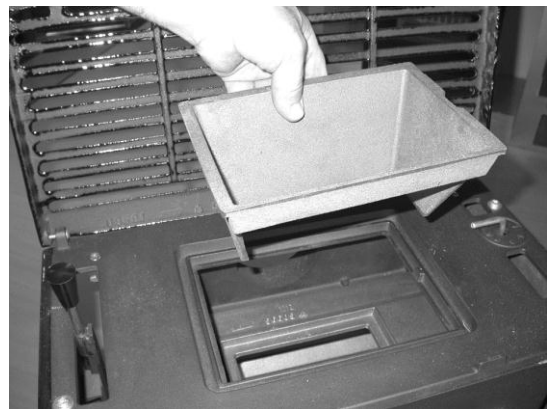
Abbildung 10: Entfernen des Ringkanaleinsatzes
