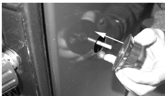
Abbildung 3: Montage des Leistungsreglerknopf
