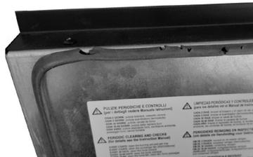
Fig. 21 - Verschlechterte Dichtung
