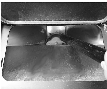
**Fig. 30 - Reinigung Tank**
