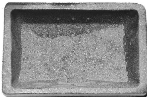
Fig. 28 - Beispiel für eine schmutzige Brennschale
