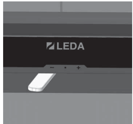
Abb. 3.13 Luftschieber ganz links, Symbol „-“ Verbrennungsluft geschlossen
