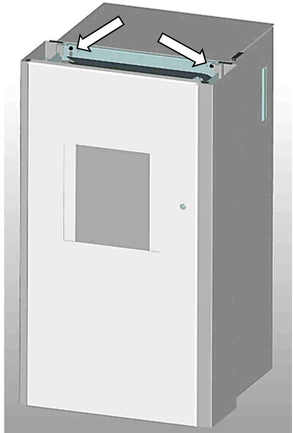
Abb. 45: Schrauben Vorderseite Frank/Frank eq
