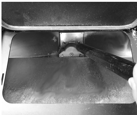
Fig. 24 - Reinigung Tank und Schnecke
