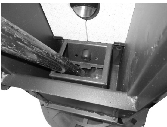
Fig. 22 - Reinigung Fach Brennschale
