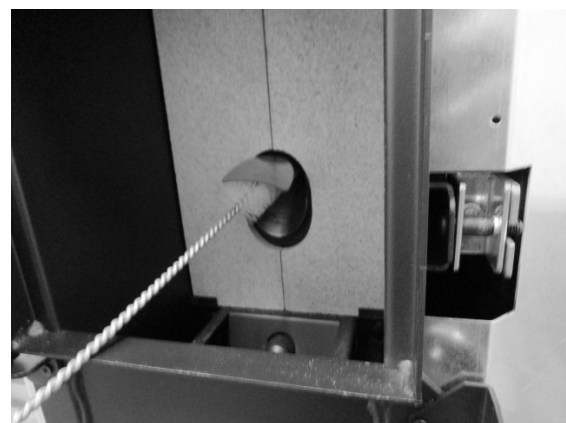
Fig. 23 - Reinigung mit Flaschenbürste
