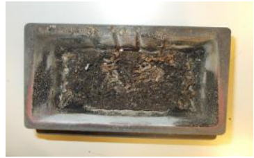
BEISPIEL VERSCHMUTZTE BRENNSCHALE
