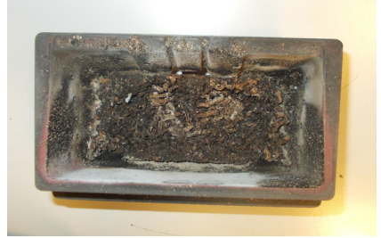
BEISPIEL VERSCHMUTZTE BRENNSCHALE
