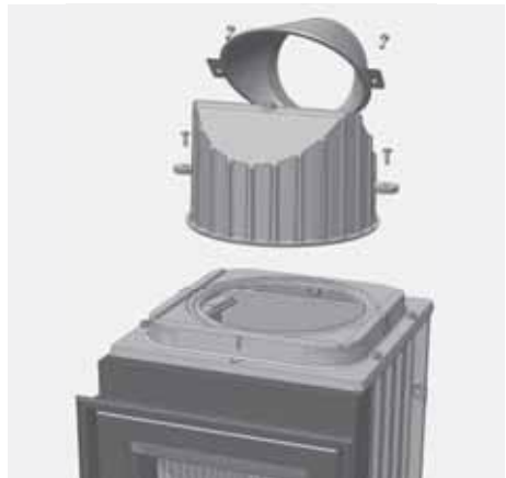
Abb. 2.23 Montage des Heizgasstutzens mit Guss-Heizgaskuppel, drehbar, Stutzen waagrecht
