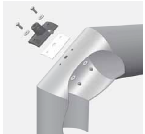
Abb. 3.1 Position des Thermosteuelements bei senkrechtem Heizgasstutzen
