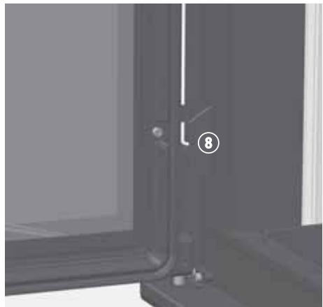
Abb. 2.42 Feuertür einhängen mit Türfeder
