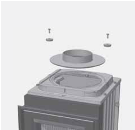
Abb. 2.22 Montage des Heizgasstutzens Ø 145 oder Ø 180
