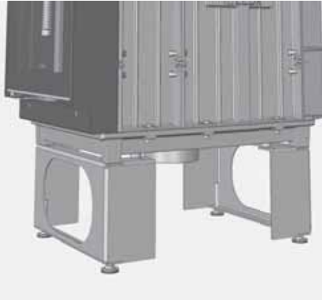
Abb. 2.3 Einschrauben der Stellfüße in Sockelelemente bei TURMA XL und TURMA XL W
