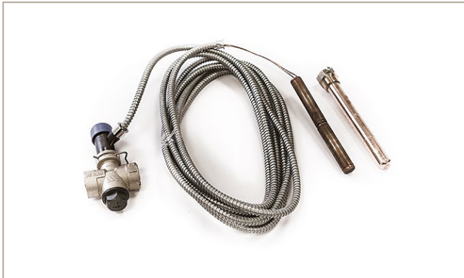
Abb. 10: Thermische Ablaufsicherung (4 m Kapillare, Tauchhülse L = 148 mm)
