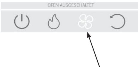
Auf dieser Bildschirmanzeige können die Belüftungsleistungen für die einzelnen Gebläse gesteuert werden.
